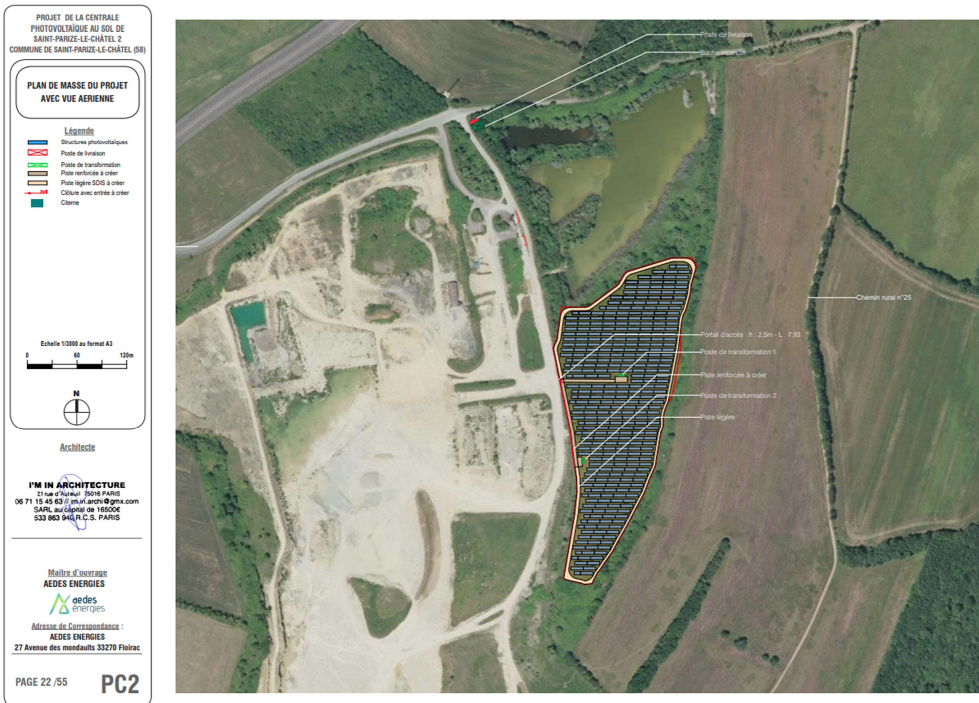
Figure 17 : Schéma d'implantation des panneaux photovoltaïques
