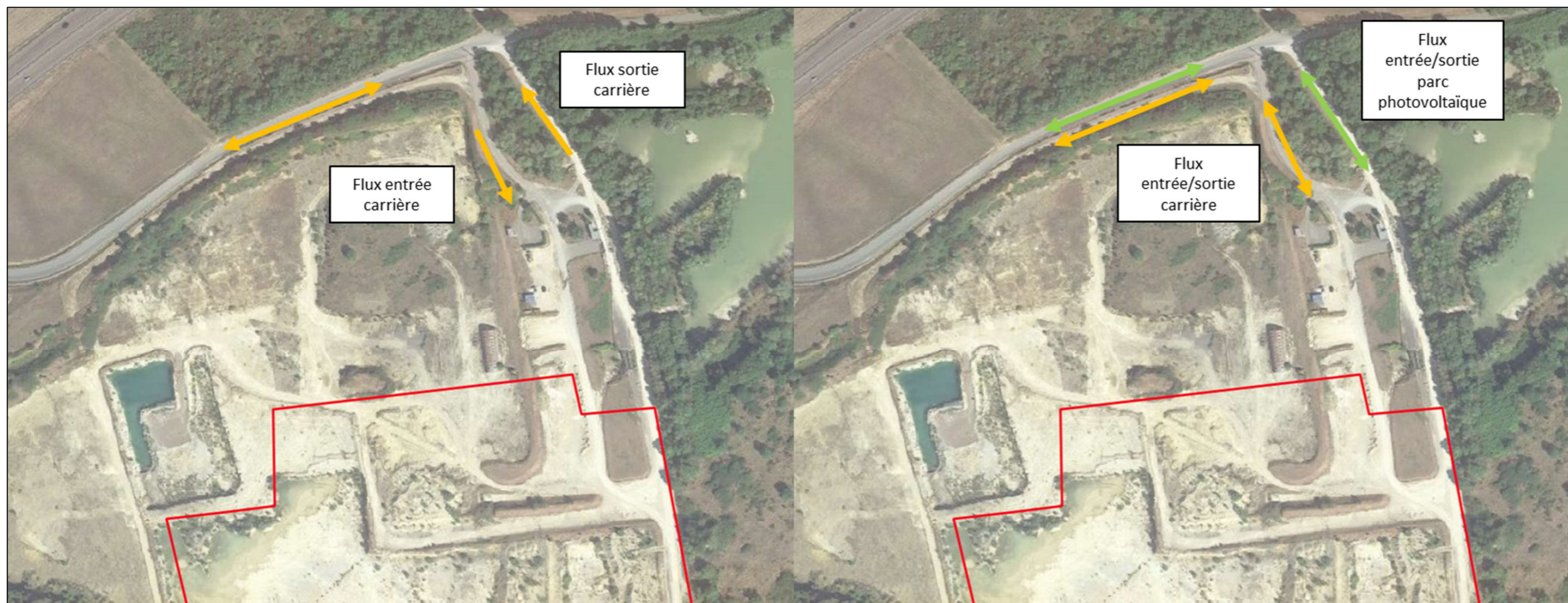
Figure 103 : Voies et sens de circulation avant travaux (gauche) et après début des travaux d'aménagement du parc photovoltaïque (droite)
