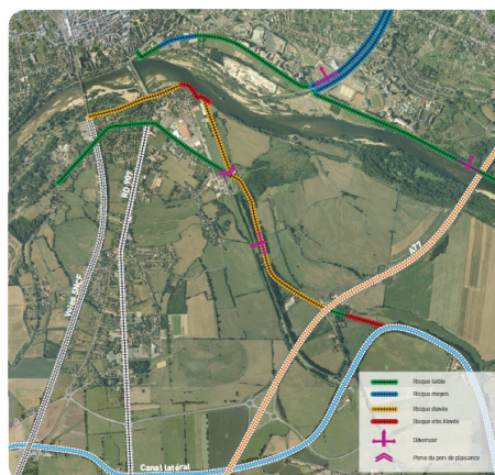
Risque de brèches dû à l'état des levées
