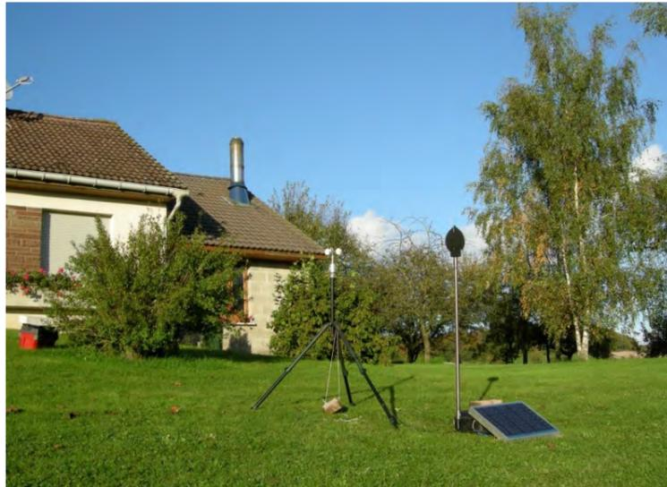
Figure 10 : Photographie d'un sonomètre en cours d'utilisation
