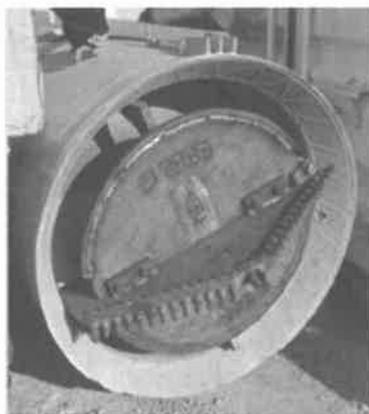
Figure 3 : Photographie d'un tuyau équipé d'une tarière et d'une trousse coupante.
