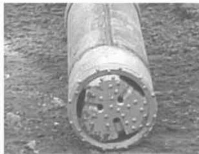
Figure 11 : Photographie de tuyau équipé d'un marteau fond de trou
