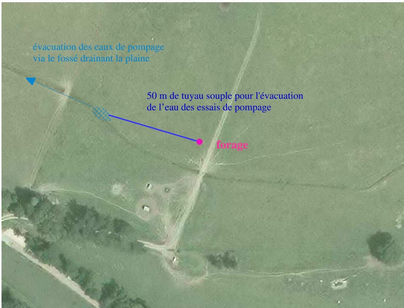
Un suivi piézométrique sur les forages de la grève et du pivot de la Grève est demandé. Le suivi consistera à installer une sonde enregistreuse (capteur de pression en eau) avec un enregistrement continu tous les 5 minutes et à procéder à 2 ou 3 mesures quotidiennes de vérification.
