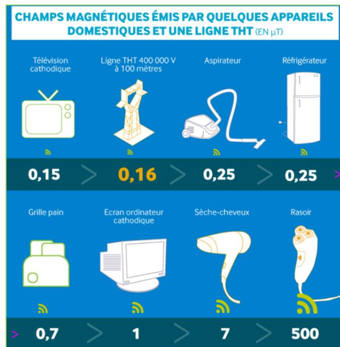
Figure 138 - Exemples d'émissions de champs électriques et magnétiques (source : RTE)
