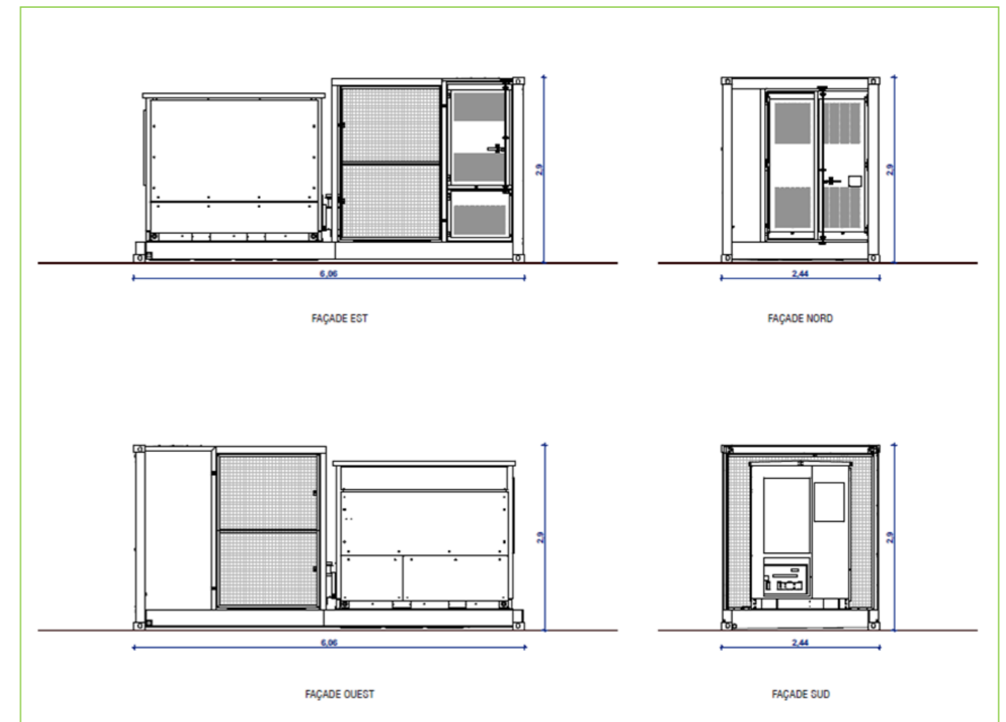
Figure 22 – Plan d'un poste de transformation (source : ADEN)
