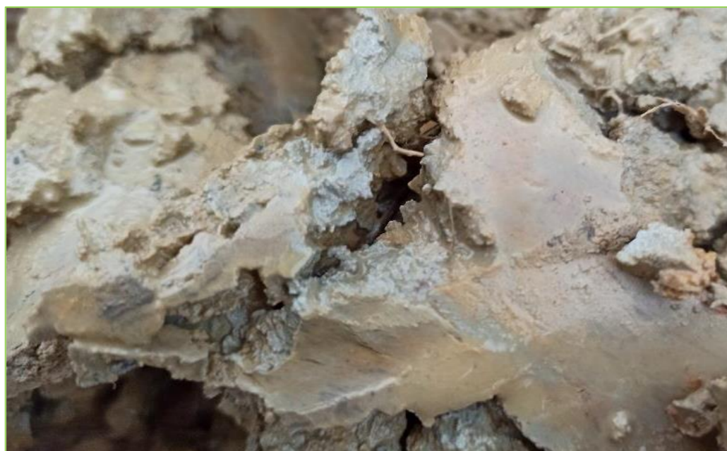
Photographie 2 - Les traits réductiques correspondent à des traces grises-bleues dans le sol (source : Eco-Stratégie)
