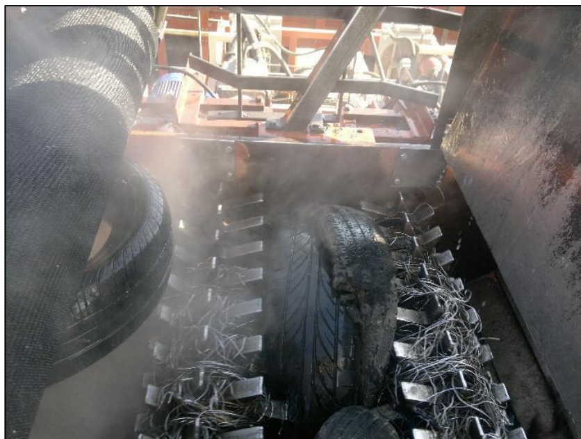
Figure 7 : Cisaille rotative en fonctionnement
