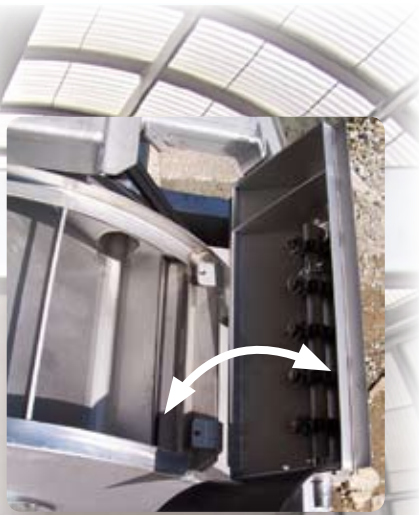
Rampe réversible ouverte pour un accès simple et rapide aux buses.
