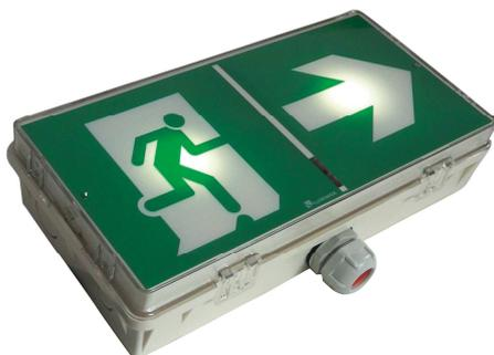
Les blocs autonomes d'intervention seront de type EDF LP 100, IP44, IK 08, 100 lumens non permanents homologués, à fluorescence, de chez Luminox.
