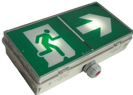
Les blocs autonomes d'intervention seront de type EDF LP 100, IP44, IK 08, 100 lumens non permanents homologués, à fluorescence, de chez Luminos.
