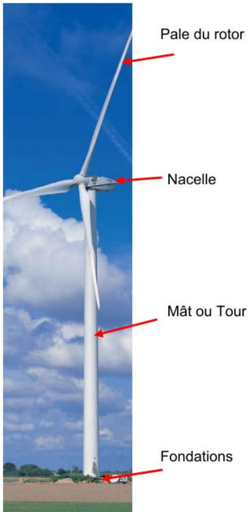
FIGURE 7 : DESCRIPTION D'UNE EOLIENNE
