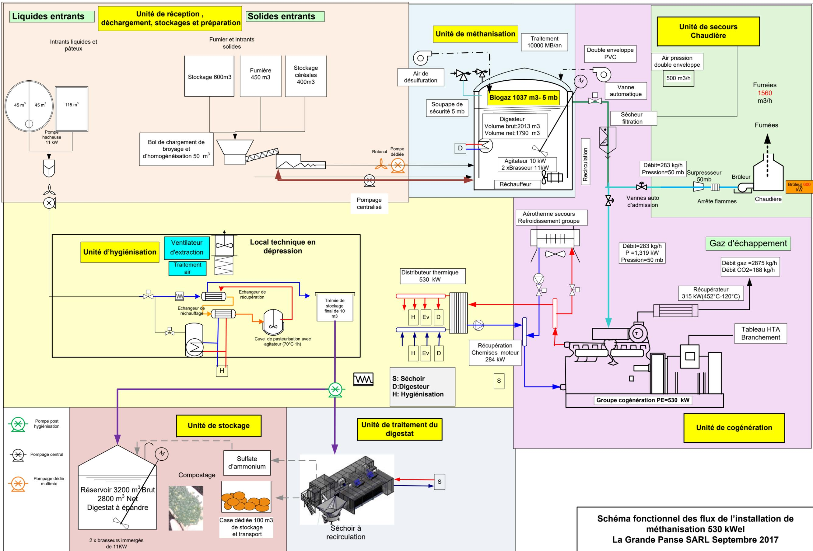
**Schéma fonctionnel des flux de l'installation de méthanisation 530 kWel**
