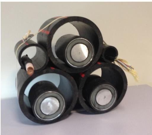
Exemple de pose en fourreaux PEHD - Liaison simple
